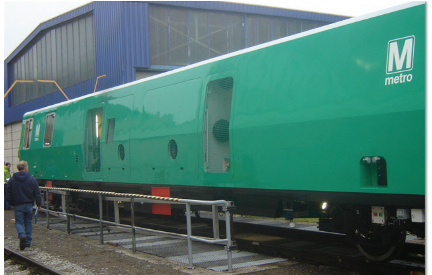
Véhicule pour rail équipé d'un système de détection des défauts des rails
