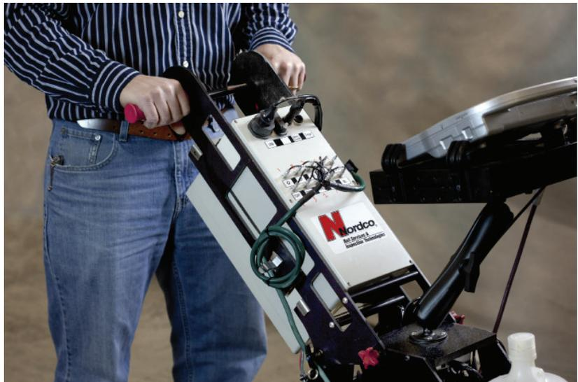
One Pass - Système d'inspection des rails par ultrasons
